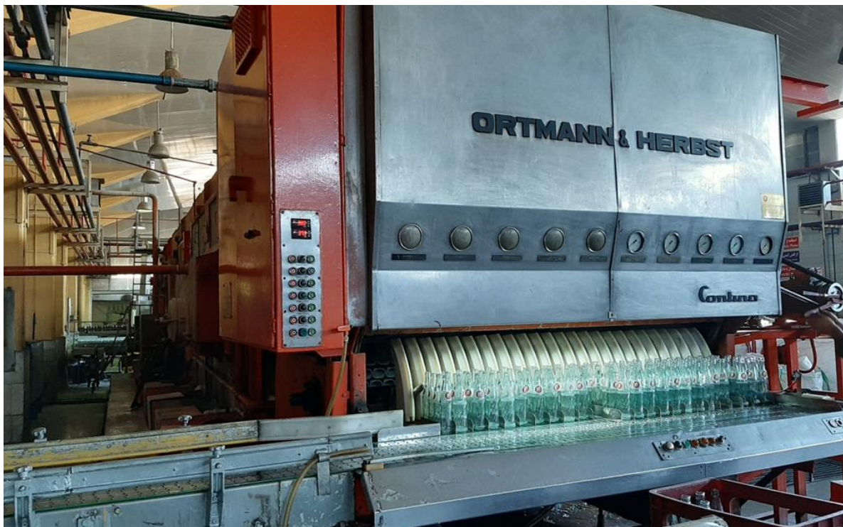
شکل ۵: نمایی از قسمت خروجی دستگاه بطری شوی
